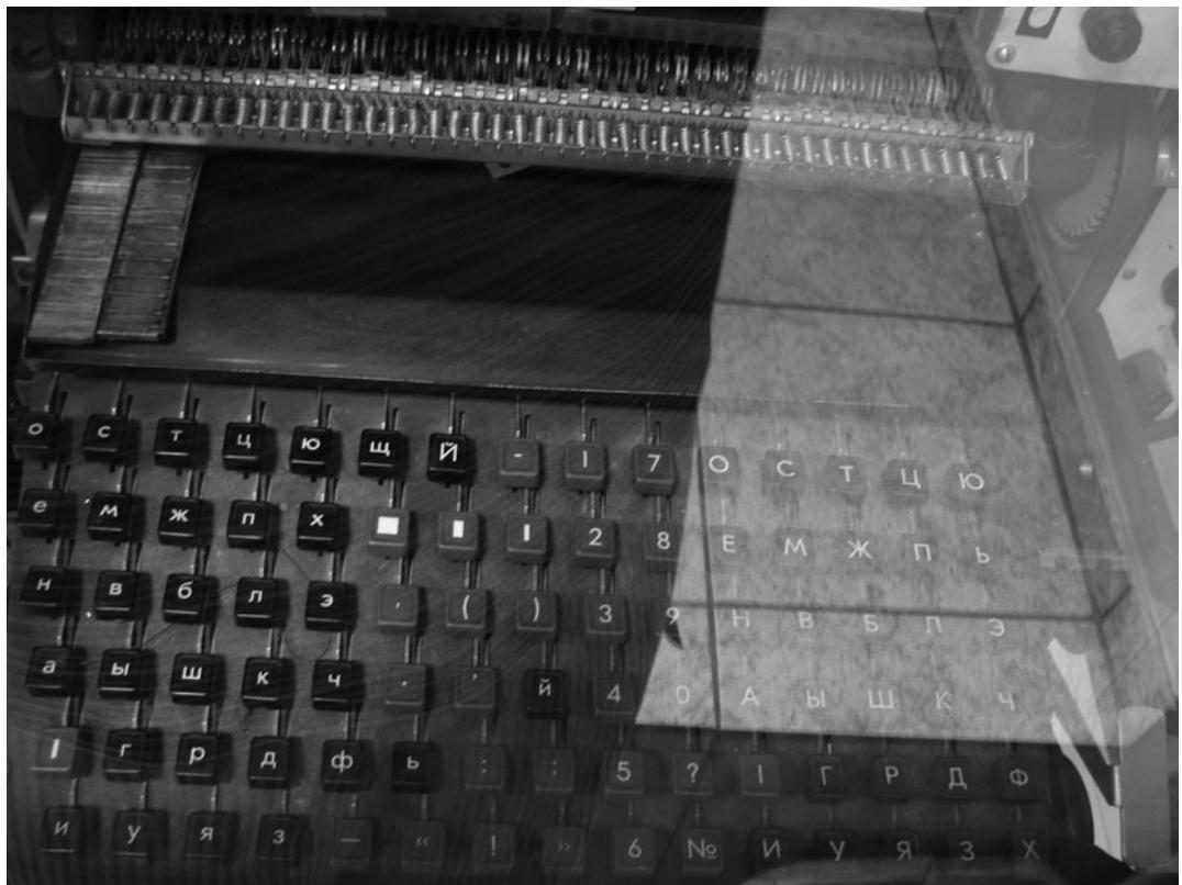
Линотип при последовательном нажатии клавиш собирал строку из матриц, с помощью изменения величины межсловных пробелов придавал ей нужную длину, а затем отливал целую строку текста (*line of type*).
